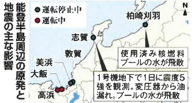
能登半島地震では、志賀原発原子炉建屋地下二階で5弱、399ガルを計測し、その揺れで「トランス及び接続配管」などが破損して大量の油が漏れ出たのは周知の事実です。このことは、志賀原発は1000ガルに耐えるなどと言ってきたことがたんなる画餅でしかなかったことが証明したのです。
