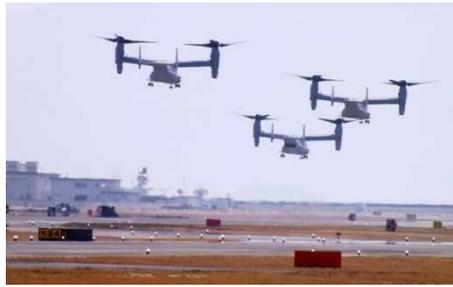
1.5m間隔で左右2つのエンジンがあり、片方が乱気流に入った場合や両側で空気の渦の構造が違う場合など左右のバランスをとるのが難しい→構造的に風や乱気流に弱いのではないのでしょうか。
